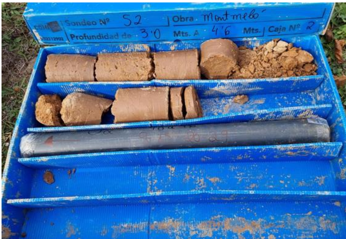
Fotografies de les caixes de recuperació del testimoni del sondeig S-2 de la fondària de 0 m a 3 m i de 3,00 m a 4,60 m.
