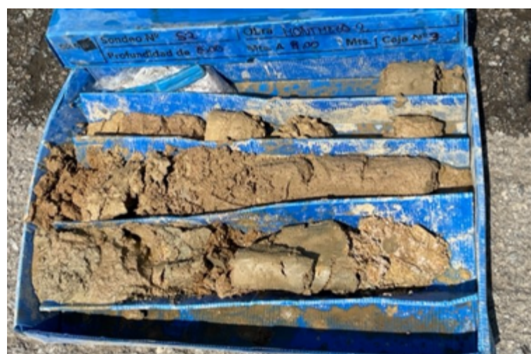
Fotografies de les caixes de recuperació del testimoni del sondeig S-2 de la fondària de 0 m a 3 m i de 3,00 m a 6,00 m.
