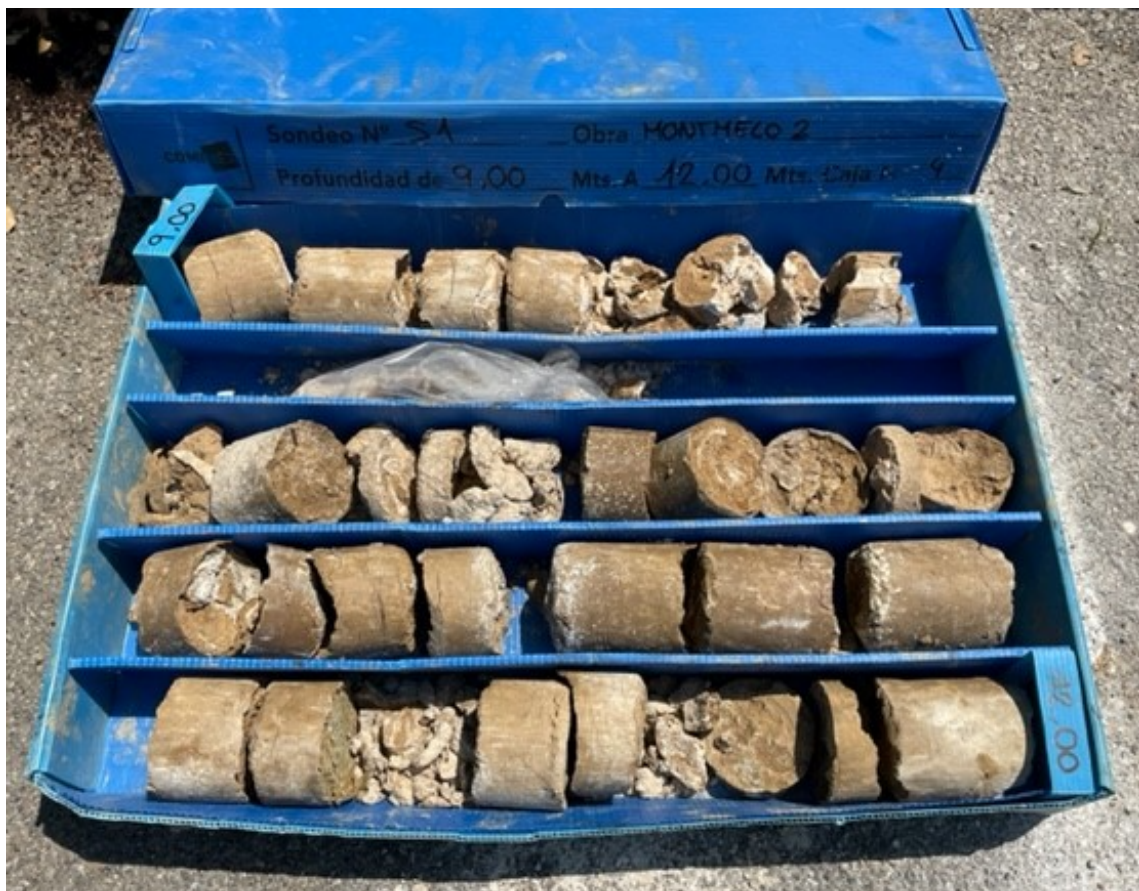
Fotografies de les caixes de recuperació del testimoni del sondeig S-1 de la fondària de 6 m a 9 m i de 9,00 m a 12,00 m.
