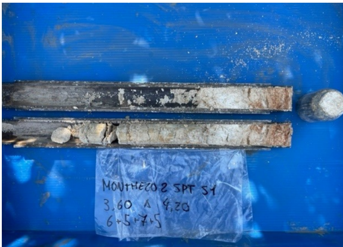
Fotografies dels portatestimonis de recuperació dels assaigs de penetració estàndards SPT-1 i SPT-2 realitzats in situ en el sondeig S-1 a la fondària d' 1,20 m a 1,80 m i de 3,6m a 4,2 m.
