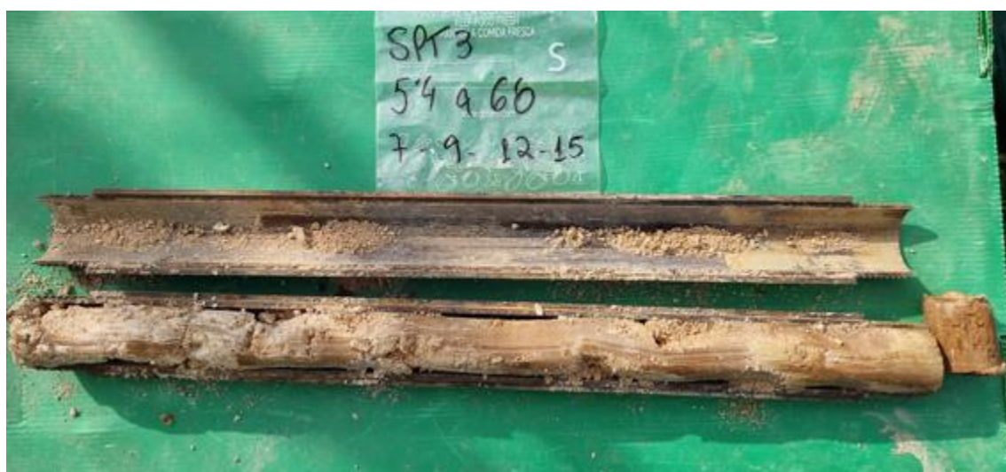
Fotografies dels portatestimonis de recuperació dels assaigs de penetració estàndars SPT-1, SPT-2 i SPT-3 realitzats in situ en el sondeig S-1 a la fondària de 0,6 m a 1,20 m , d'1,60 m a 2,20 m, i de 5,4 m a 6,00 m.
