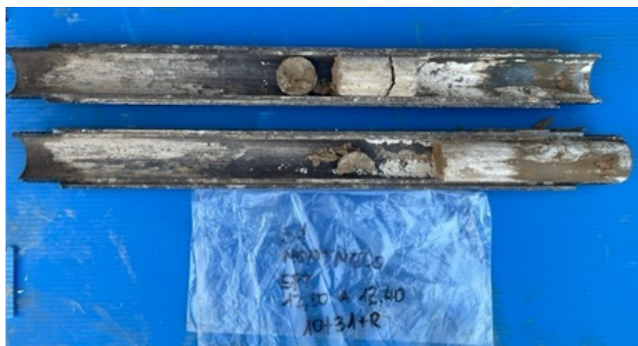
Fotografies dels portatestimonis de recuperació dels assaigs de penetració estàndards SPT-3, SPT-4 i SPT-5 realitzats in situ en el sondeig S-1 a la fondària de 7,20 m a 7,80 m , de 9,60 m a 10,20 m i de 12,0 m a 12,4 m.
