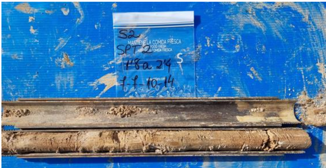
Fotografia del portatestimonis de l'assaigs SPT-2 realitzat in situ en el sondeig S-2 de la fondària d'1,8 m a 2,4 m.
