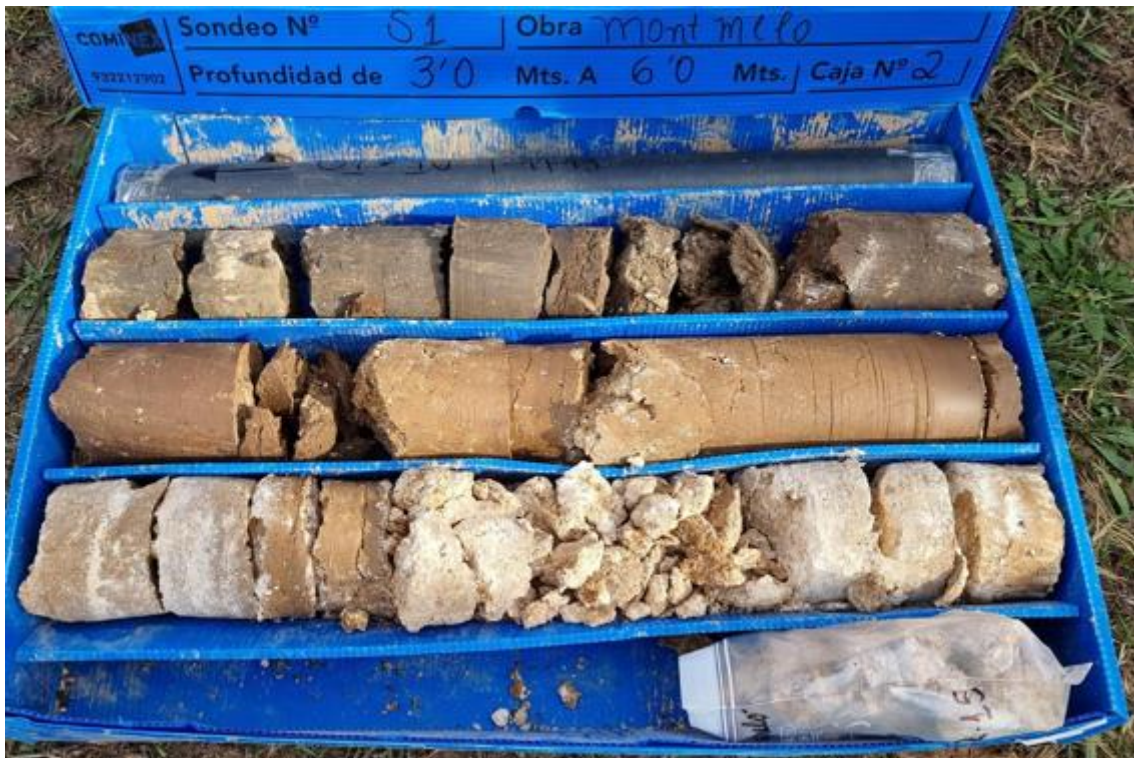
Fotografies de les caixes de recuperació del testimoni del sondeig S-1 de la fondària de 0 m a 3 m i de 3 m a 6,00 m.
