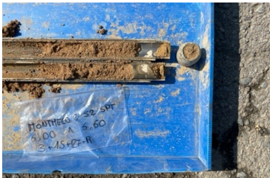
Fotografies dels portatestimonis dels assaigs SPT-1, SPT-2, SPT-3 realitzats in situ en el sondeig S-2 de la fondària d' 1,20 m a 1,8 m , de 3,00 m a 3,60 m i de 6,00 m a 6,60 m.
